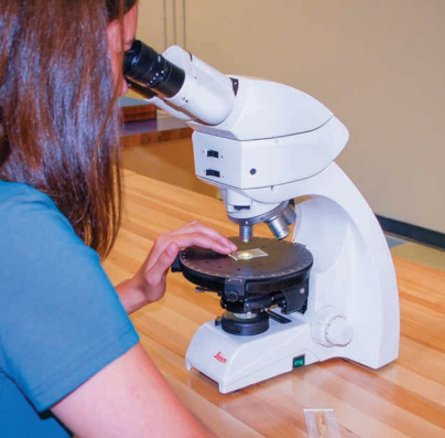
Microscope pétrographique d'usage courant dans les laboratoires de géologie
