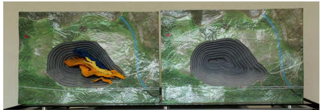
Voici un modèle en 3D du projet PAK de Frontier Lithium situé à 175 km au nord de Red Lake. La partie à ciel ouvert de ce projet d'extraction de lithium est située à environ 200 mètres de profondeur et mesure 400 mètres de largeur. Ce modèle illustre l'apparence qu'aura cette mine à ciel ouvert une fois les minerais en surface extraits. Les galeries souterraines de la mine sont présentées en noir et le corps de minerai en orange. Photos reproduites avec l'autorisation de Frontier Lithium
